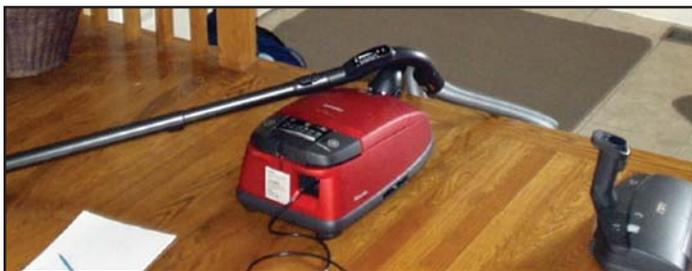
**Figure 1** Aspirateur équipé d'un filtre HEPA avec une brosse de battage en accessoire, prêt à entamer la première étude
